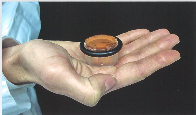
Der Messkopf des „Glucolight“ mit der „smarten“ Membran (Bild: Empa)
